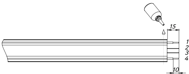
Рисунок 7. Пример нанесения клея на тканевую основу и зачистки датчика
